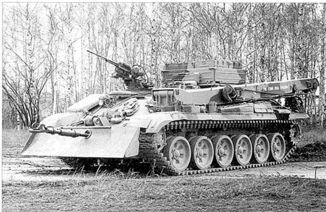
Модернизированный БРЭМ-1. Вид спереди.
