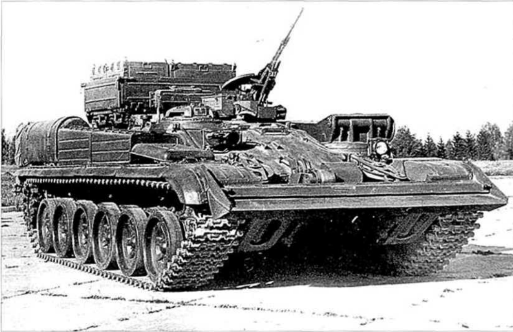
Полигонно-войсковые испытания опытного образца бронированной ремонтно-эвакуационной машины (БРЭМ) "объект 608". сентябрь 1974 г. Обратите внимание на оригинальную зенитную пулеметную установку с дистанционным управлением (закрытого типа).
