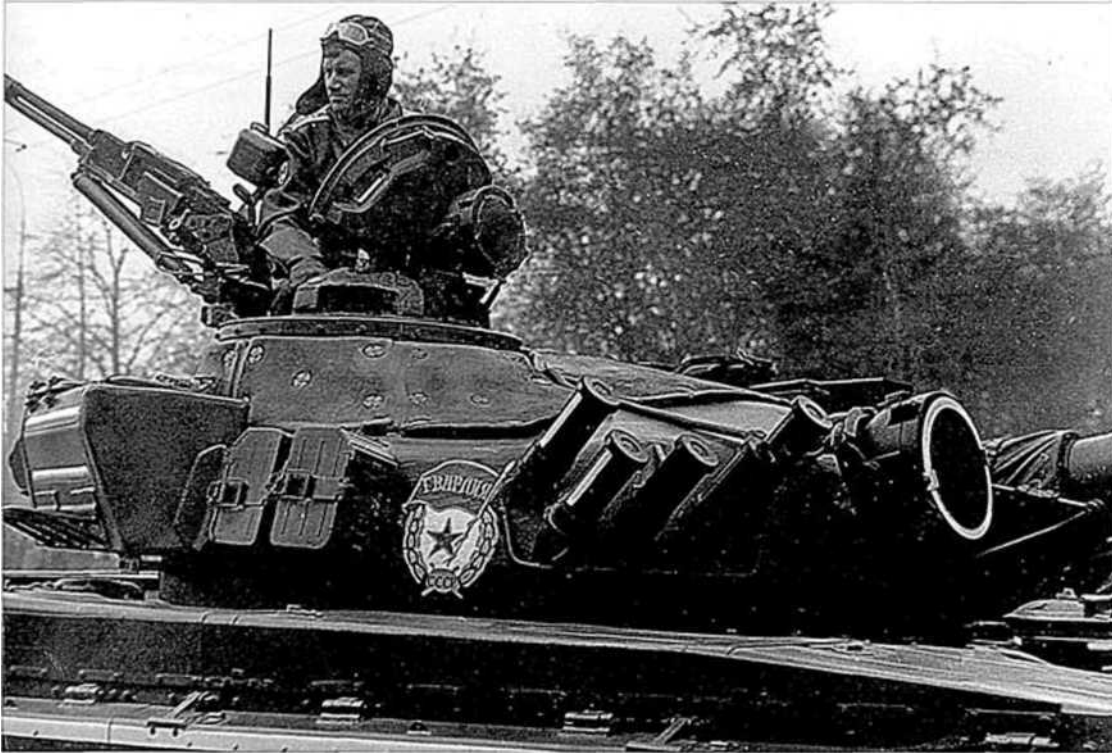
Башня танка Т-72А образца 1983 г Обратите внимание на антинейтронный подбой, установленный на крыше башни.
