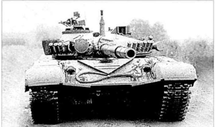
Танк М-84А - хорватская модернизация югославского танка М-84А (вариант Т-72М1).
