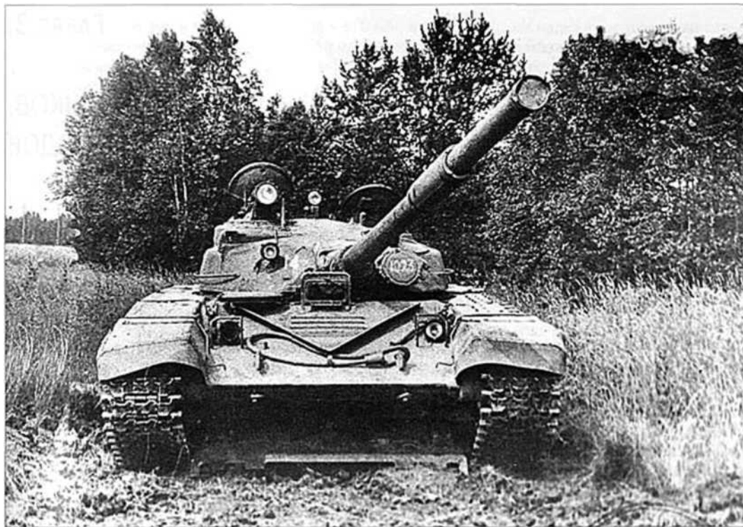
Танк "объект 172М" с оборудованием для самоокапывания в рабочем положении, июль 1972 г.
