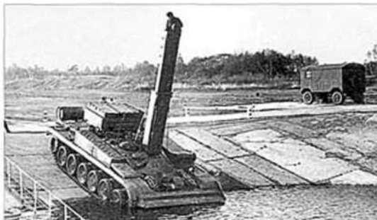
БРЭМ "объект 608" с установленной трубой-лазом преодолевает водную преграду.
