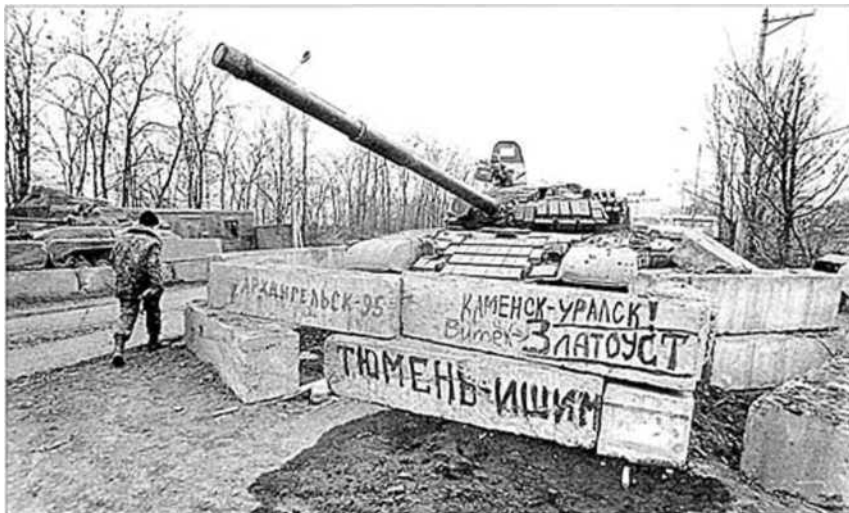
Танк Т-72Б с навесной динамической защитой на блок-посту российских войск при въезде в аэропорт Грозный-Северный 4 апреля 1995 г.
