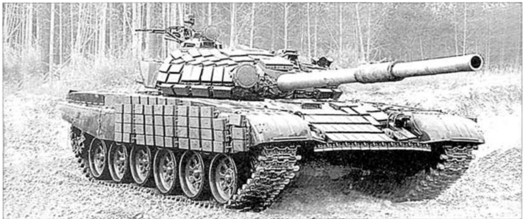
Танк Т-72Б образца 1984 года с навесной динамической защитой.
