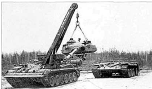
Передвижение БРЭМ "объект 608" с башней танка Т-72 в ходе полигонно-войсковых испытаний.
