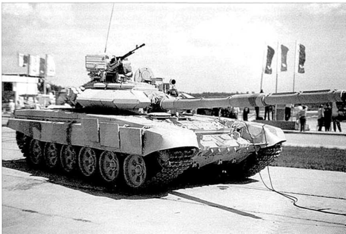
Танк Т-90С со сварной башней, изготовленный в рамках контракта с Индией, на Тагильской выставке вооружений 2002 г.
