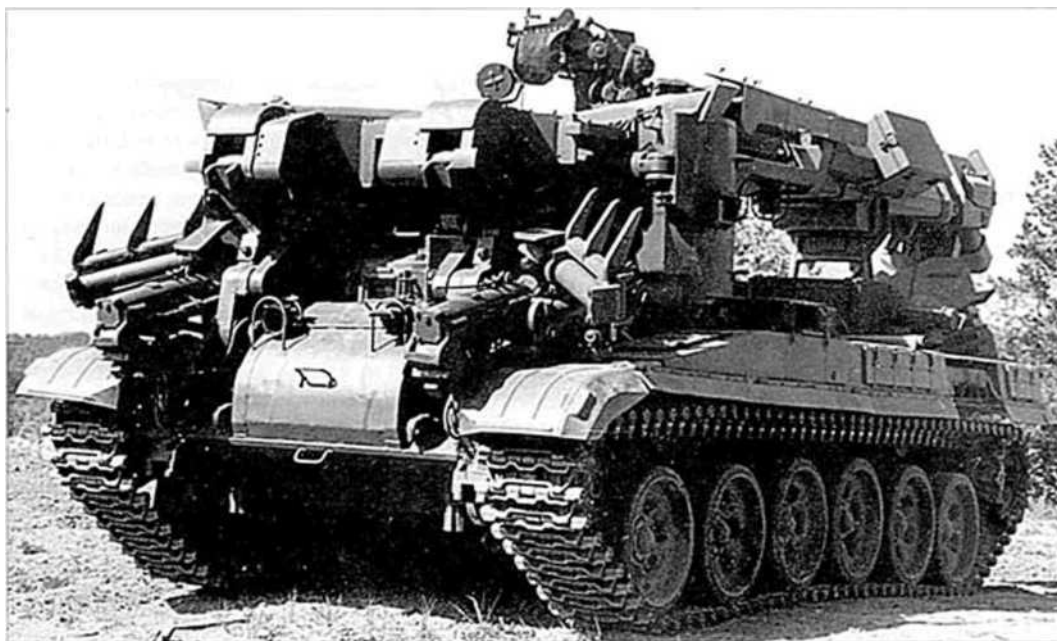
ИМР-3М. Управляемое рабочее оборудование в походном положении.
