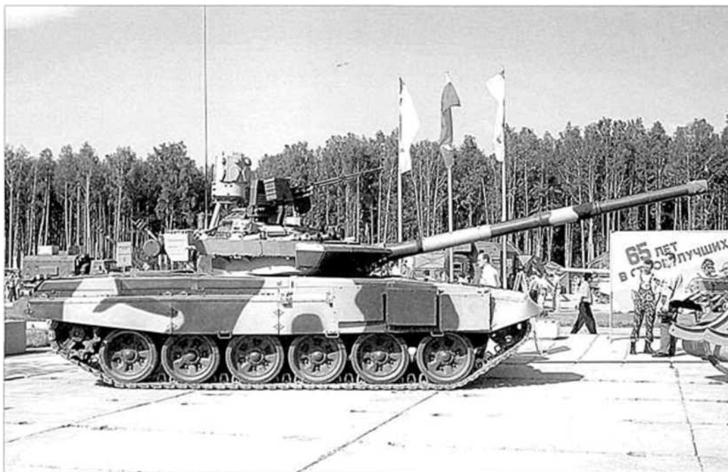
Модернизированный танк Т-72М1 с комплексом активной защиты "Арена". Вид на правый борт.
